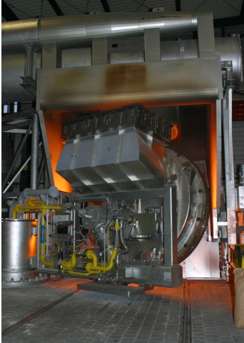
Innovativer Dreh- und kipperbarer Raffinationsofen für Kupferschrotte bei KME in Osnabrück
