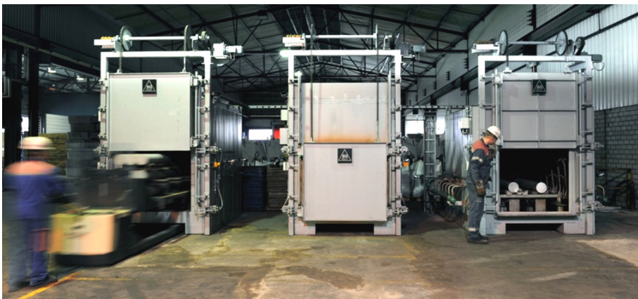
Fertig für den Transport zum Kunden: TRIMET-Mitarbeiter entnehmen die abgekühlten Bolzen aus der Wasserkühlkammer (links) und der Luftkühlkammer (rechts).
